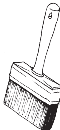
Nutida plafondpensel. Har en mycket vid användning, företrädesvis för vattenbaserade färger. Ill. Bertil Bonns.
