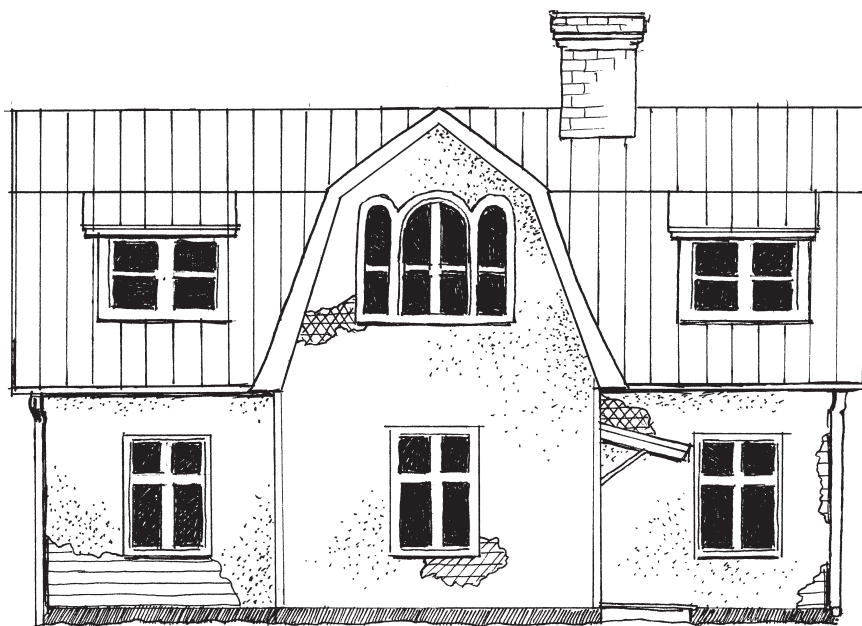
Vanliga skador på putsade fasader. Illustration Tomas Hultman.
