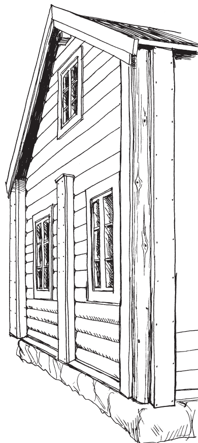
Knutbrädor har sedan länge använts för att skydda knutskallarna. Ill. Tomas Hultman.
